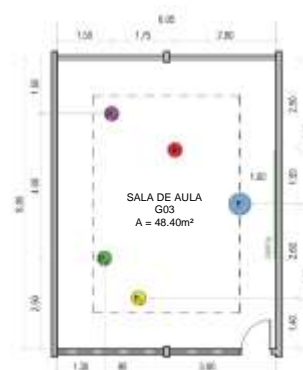
Figura 3 - Pontos de medição na sala G03.
